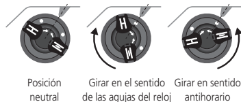
Fig. 1.2.1 Mandos de control local ABRIR/CERRAR del actuador IQ3 Perform
