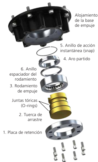
Fig. 5.1.4 Montaje de base F25 & F30
