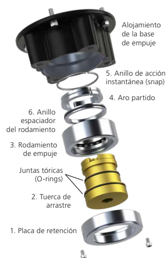
Fig. 5.1.3 Montaje de base F14 & F16
